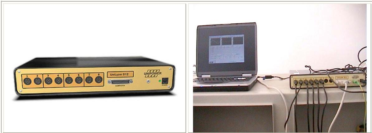
Se dispone de dos de estos equipos de medida exactamente iguales, lo cual permite realizar las medidas en dos puntos de la red eléctrica general o interior de la factoría al mismo tiempo, programando convenientemente los equipos. El analizador U812, es un equipo de medida de perturbaciones que dispone de 8 entradas analógicas, con una máxima amplitud de entrada de 283 mV, una impedancia de entrada de 10 MOhmios y un error del 0,1%.
