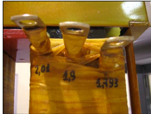
Fig. 11. Detalle de tomas de regulación en L2
